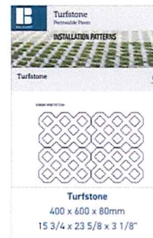
10 Turfstone Pavers (P7) Scale: NTS
